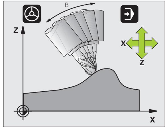
TCPM 功能是对 M128 功能的改进，用它可以在定位旋转轴时确定 TNC 的特性。与 M128 不同，TCPM 功能允许定义多个功能的工作模式：
