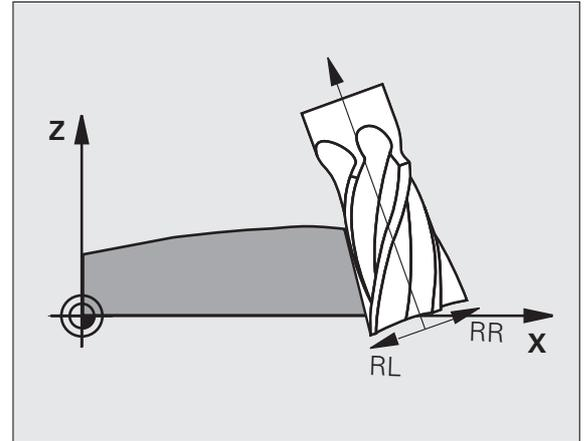
有两种确定刀具定向方向的方法：
