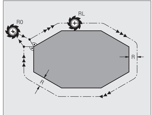
对于半径补偿，TNC 考虑 **TOOL CALL**（刀具调用）程序段和刀具表的差值：
