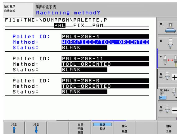
用相应软键可操作输入窗体的不同层面。系统将在输入窗体状态行中高亮当前层面。当用屏幕布局按钮切换为表视图时，光标将位于输入窗体视图的相同层面上。
