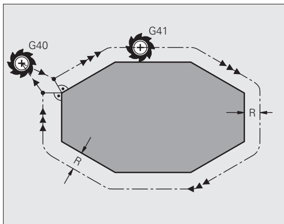
对刀具半径补偿而言，TNC 系统使用的差值考虑 T (刀具调用) 程序段和刀具表两方面因素：
