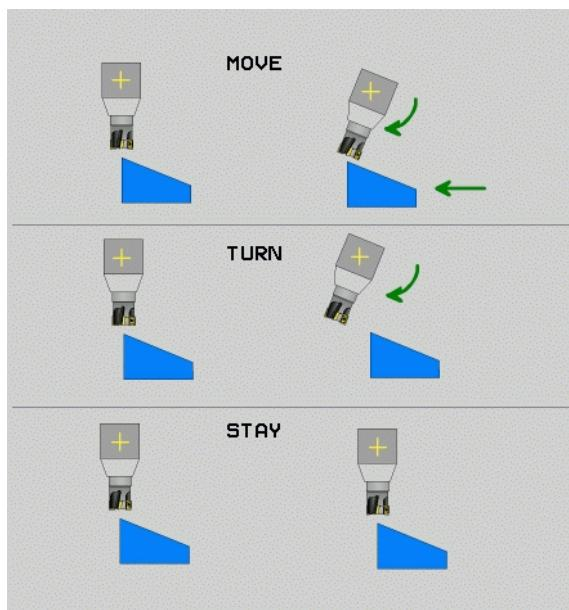
► **偏移刀尖 — 旋转中心** (增量值) : TNC 相对刀尖倾斜刀具 (或工作台)。距离参数定义相对当前刀尖位置进行定位运动的旋转中心。
