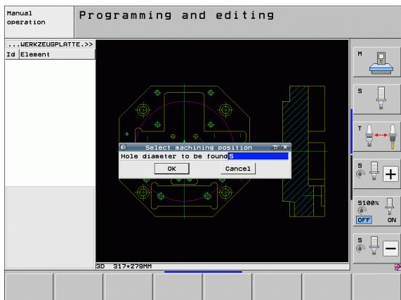
▶ 输入所需直径和用 ENT 键确认：TNC 搜索 DXF 文件中的输入直径，然后在弹出窗口中显示最接近输入直径的所选直径。也可以根据孔的尺寸进行过滤
