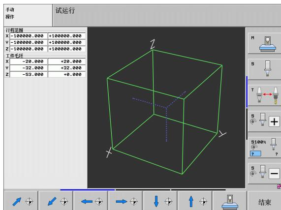
在“测试运行”操作模式下，可以启动加工区监测功能，以便测试程序中的当前原点和行程范围（参见下表最后一行）。
