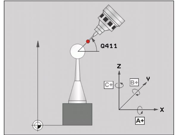
Se, durante a maquinação, for possível deixar a esfera de calibração fixa na mesa da máquina, pode-se, por exemplo, compensar um desvio da máquina. Este processo também é possível numa máquina sem eixos rotativos.
