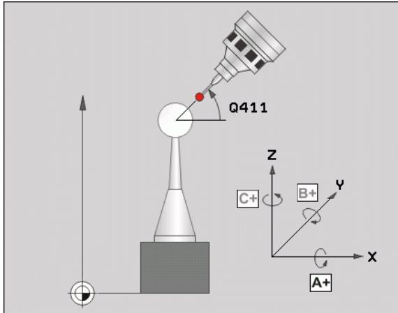
İşlem esnasında kalibrasyon bilyesini makine tezgahına sabitlenmiş olarak bırakabilirsiniz, örneğin makinenin bir sapmasını dengeleyebilirsiniz. Bu işlem döner ekseni olmayan bir makinede de mümkündür.
