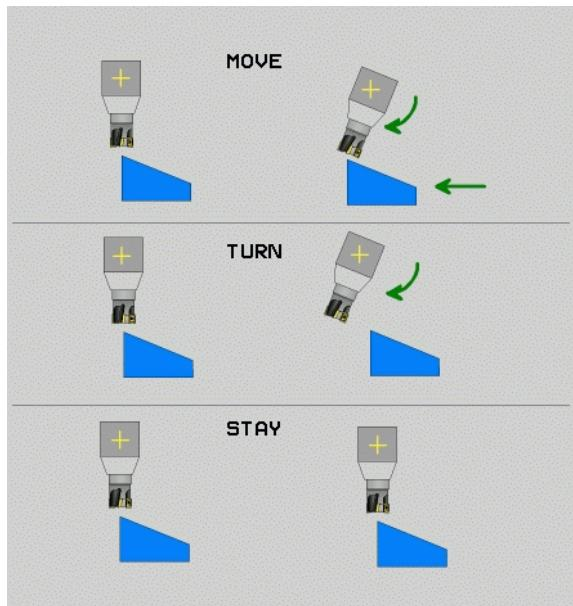
► **偏移刀尖—旋转中心 (增量值)** : TNC 相对刀尖倾斜刀具 (或工作台)。SET UP (设置) 参数定义相对当前刀尖位置平移倾斜运动的旋转中心。
