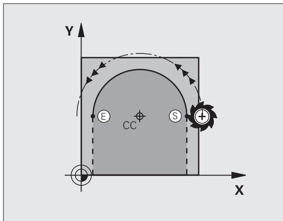
通常，TNC 在当前加工面进行圆弧运动。如果编程圆弧不在当前加工面上，例如 G2 Z... X...，刀具轴为 Z 轴，同时进行旋转运动，TNC 将沿空间圆弧，即 3 个轴的圆弧，进行刀具运动。
