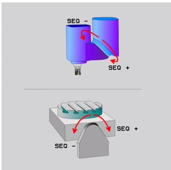
举例，C 轴回转工作台和 A 轴倾斜工作台的机床。编程功能：PLANE SPATIAL ( PLANE 空间角 ) SPA+0SPB+45SPC+0
