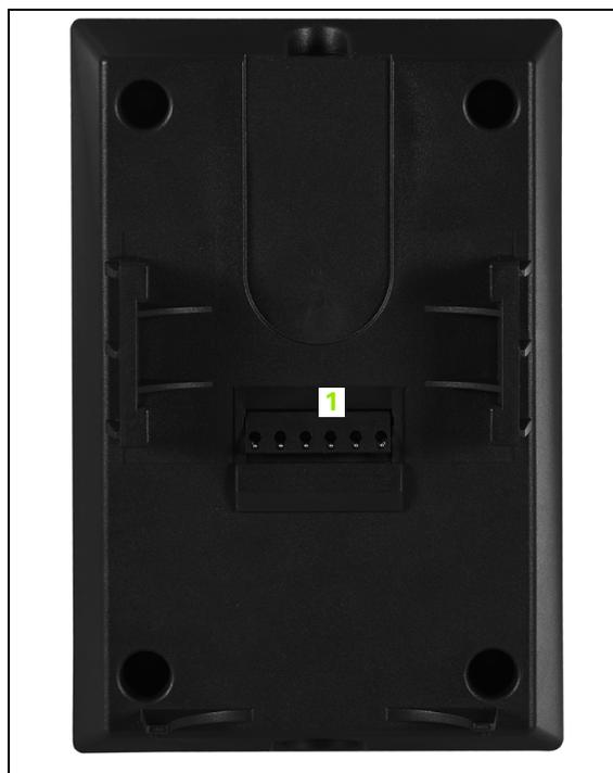
Das Funkhandrad HR 550 FS ist mit einem Akku ausgestattet. Der Akku wird geladen, sobald Sie das Handrad in die Handrad-Aufnahme (siehe Bild) eingelegt haben.
