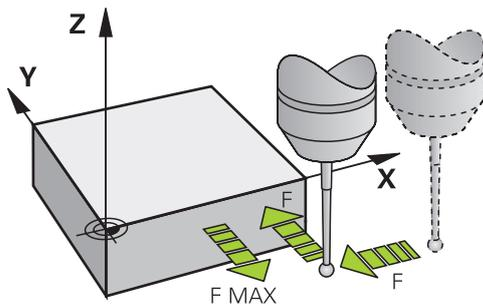
Con las funciones de palpación se pueden fijar puntos de referencia en la pieza, realizar mediciones en la pieza, así como calcular e inclinar posiciones inclinadas de la pieza.
