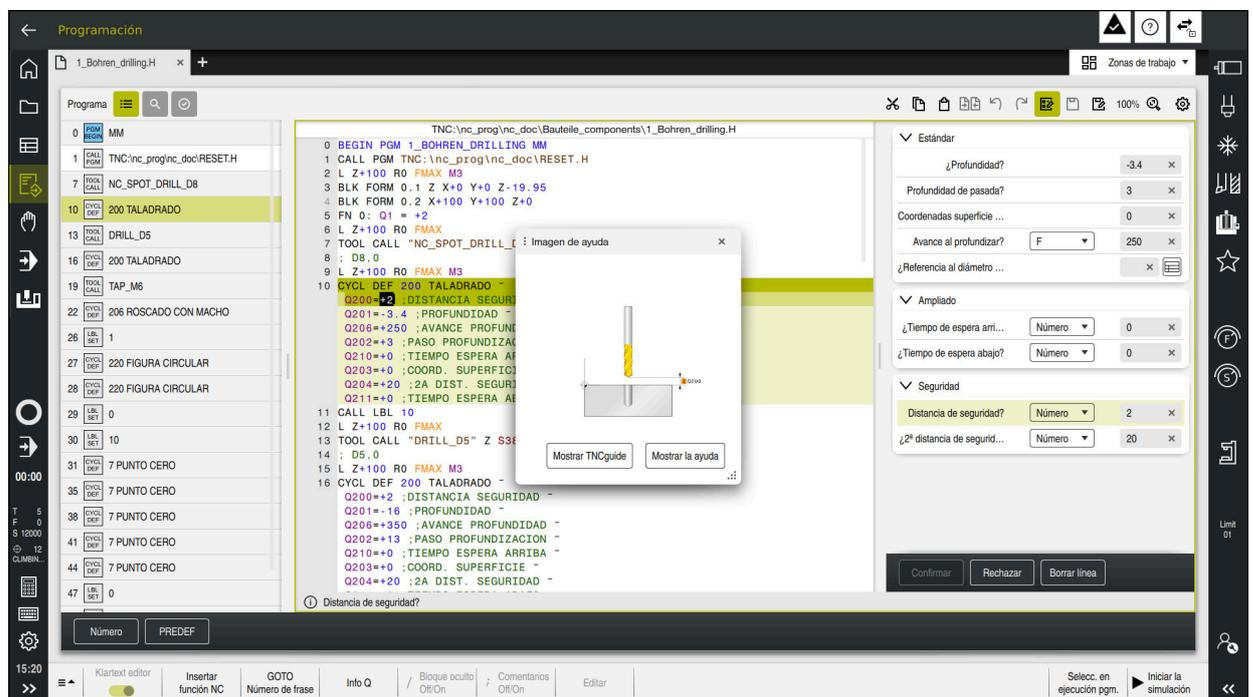
Los ciclos se guardan en el control numérico como subprogramas. Con los ciclos se pueden ejecutar diversos mecanizados. De este modo, la creación de programas se simplifica enormemente. Los ciclos también son útiles para los mecanizados que más se repiten y que comprenden varios pasos de mecanizado. La mayoría de ciclos utilizan parámetros Q como parámetros de transferencia. El control numérico ofrece ciclos para las siguientes tecnologías:
