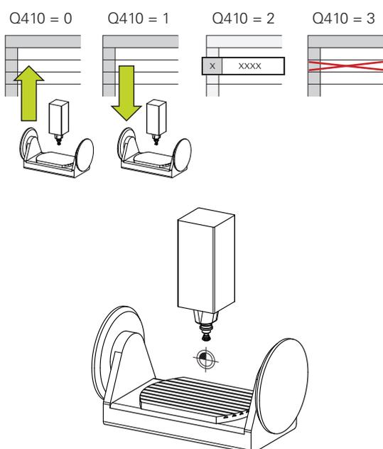
Con el ciclo de palpación **450** se puede guardar la cinemática activa de la máquina o restaurar una cinemática de máquina anteriormente guardada. Los datos guardados se pueden mostrar y borrar. En total se dispone de 16 posiciones de memoria.
