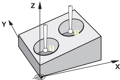
En este ejemplo se alinean dos taladros. Las palpaciones tienen lugar en el eje X (eje principal) y en el eje Y (eje auxiliar). Por este motivo, es obligatorio definir la posición nominal del dibujo para estos ejes. La posición nominal del eje Z (eje de la herramienta) no es imprescindible, ya que no toma ninguna medida en esta dirección.
