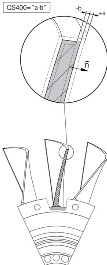
El ciclo **444** comprueba un punto individual en la superficie de un componente. Este ciclo se emplea p. ej. para medir en matrices y superficies de forma libre. Puede determinarse si un punto en la superficie del componente se encuentra en la zona de medida excesiva o en la de medida insuficiente en comparación con una coordenada teórica. A continuación, el usuario puede ejecutar otros pasos del trabajo tales como repasar el mecanizado etc.
