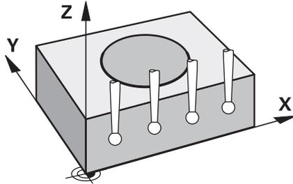
Con el ciclo **1493** se pueden repetir los puntos de palpación de determinados ciclos de palpación a lo largo de una recta. La dirección, la longitud y el número de repeticiones se definen en el ciclo.
