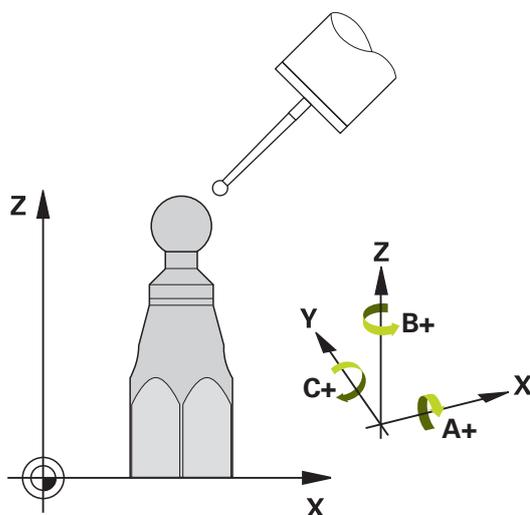
Con el ciclo de palpación **452** es posible optimizar la cadena de transformación cinemática de la máquina (ver "Ciclo 451 MEDIR CINEMATICA (#48 / #2-01-1)", Página 405). A continuación, el control numérico corrige el sistema de coordenadas de pieza también en el modelo cinemático para que el punto de referencia actual después de la optimización se encuentra en el centro de la bola de calibración.
