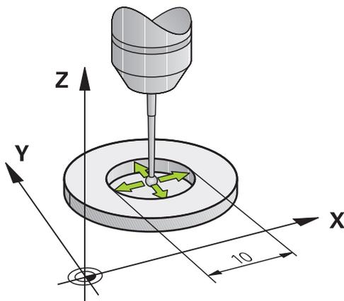
Antes de iniciar el ciclo de calibración se debe posicionar previamente el palpador en el centro del aro de calibración y a la altura de medición deseada.
