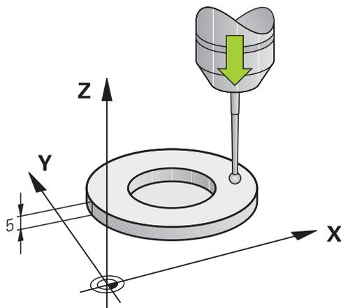
Antes de iniciar el ciclo de calibración se debe poner el punto de referencia en el eje del cabezal de tal modo que sobre la mesa de la máquina haya  $Z=0$  y posicionar previamente el palpador mediante el aro de calibración.
