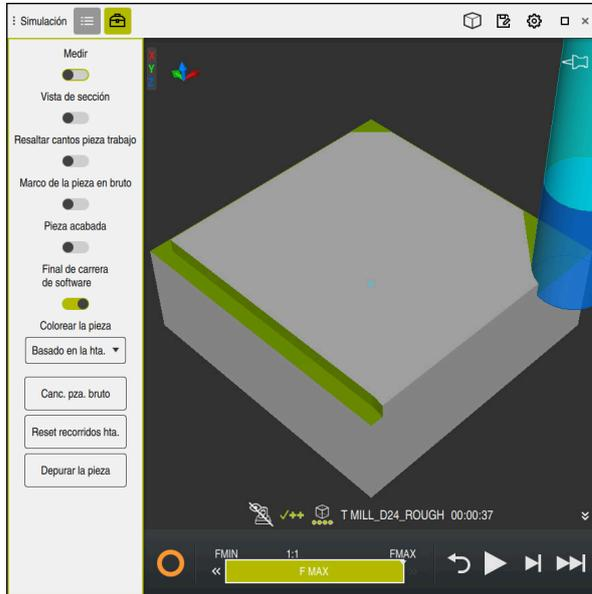
Zona de trabajo **Simulación** en el modo de funcionamiento **Programación**
