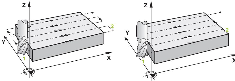
Die Strategien **Q389=0** und **Q389=1** unterscheiden sich durch den Überlauf beim Planfräsen. Bei **Q389=0** liegt der Endpunkt außerhalb der Fläche, bei **Q389=1** am Rand der Fläche. Die Steuerung berechnet den Endpunkt **2** aus der Seitenlänge und dem seitlichen Sicherheitsabstand. Bei der Strategie **Q389=0** verfährt die Steuerung das Werkzeug zusätzlich um den Werkzeugradius über die Planfläche hinaus.
