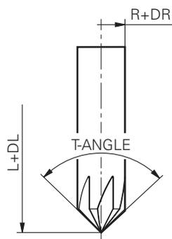
Damit die Steuerung den Zyklus **277** ausführen kann, müssen Sie das Werkzeug in der Werkzeughandlung korrekt anlegen:
