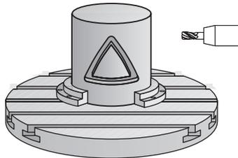
Mit diesem Zyklus können Sie eine auf der Abwicklung definierte Kontur auf den Mantel eines Zylinders übertragen. Verwenden Sie den Zyklus **28**, wenn Sie Führungsnuten auf dem Zylinder fräsen wollen.
