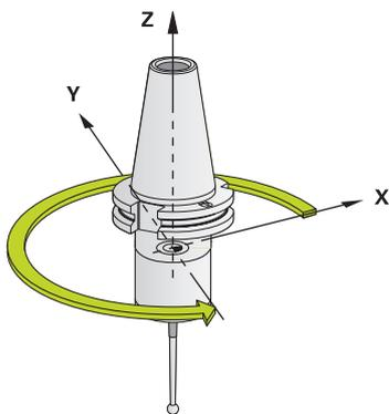
Die Steuerung kann die Hauptspindel einer Werkzeugmaschine ansteuern und in eine durch einen Winkel bestimmte Position drehen.
