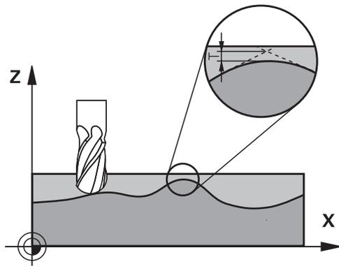
Durch die Angaben im Zyklus **32** können Sie das Ergebnis bei der HSC-Bearbeitung hinsichtlich Genauigkeit, Oberflächengüte und Geschwindigkeit beeinflussen, sofern die Steuerung an die maschinenspezifischen Eigenschaften angepasst wurde.
