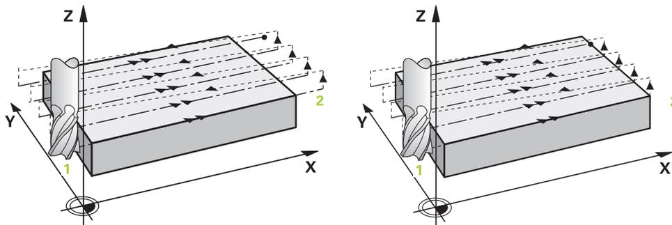
Die Strategien **Q389=2** und **Q389=3** unterscheiden sich durch den Überlauf beim Planfräsen. Bei **Q389=2** liegt der Endpunkt außerhalb der Fläche, bei **Q389=3** am Rand der Fläche. Die Steuerung berechnet den Endpunkt **2** aus der Seitenlänge und dem seitlichen Sicherheitsabstand. Bei der Strategie **Q389=2** verfährt die Steuerung das Werkzeug zusätzlich um den Werkzeugradius über die Planfläche hinaus.
