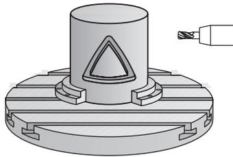
Mit diesem Zyklus können Sie eine, auf der Abwicklung definierte Führungsnut, auf den Mantel eines Zylinders übertragen. Im Gegensatz zum Zyklus **27** stellt die Steuerung das Werkzeug bei diesem Zyklus so an, dass die Wände bei aktiver Radiuskorrektur nahezu parallel zueinander verlaufen. Exakt parallel verlaufende Wände erhalten Sie dann, wenn Sie ein Werkzeug verwenden, das exakt so groß ist, wie die Nutbreite.
