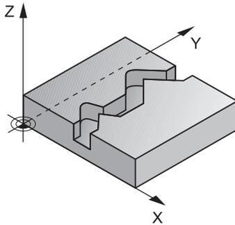
Mit diesem Zyklus lassen sich zusammen mit Zyklus **14 KONTUR** und Zyklus **270 KONTURZUG-DATEN** offene und geschlossene Konturen bearbeiten. Sie können auch mit einer automatischen Restmaterialerkennung arbeiten. Dadurch können Sie z. B. Innenecken nachträglich mit einem kleineren Werkzeug fertig bearbeiten.
