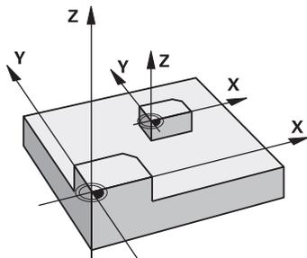
Die Steuerung kann innerhalb eines NC-Programms Konturen vergrößern oder verkleinern. So können Sie z. B. Schrumpf- und Aufmaßfaktoren berücksichtigen.
