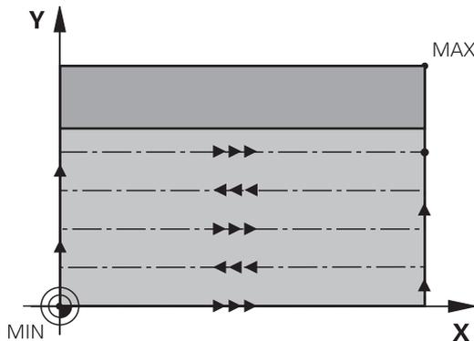
Mit den Begrenzungen können Sie die Bearbeitung der Planfläche eingrenzen, um z. B. Seitenwände oder Absätze bei der Bearbeitung zu berücksichtigen. Eine durch eine Begrenzung definierte Seitenwand wird auf das Maß bearbeitet, das sich aus dem Startpunkt bzw. der Seitenlängen der Planfläche ergibt. Bei der Schruppbearbeitung berücksichtigt die Steuerung das Aufmaß Seite – beim Schlichtvorgang dient das Aufmaß zur Vorpositionierung des Werkzeugs.
