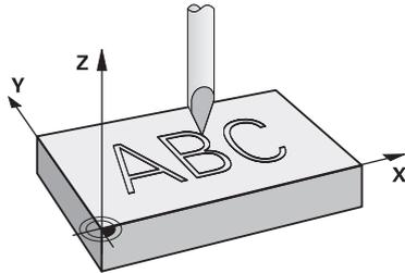
Mit diesem Zyklus gravieren Sie Texte auf eine ebene Fläche des Werkstücks. Sie können die Texte entlang einer Geraden oder auf einem Kreisbogen anordnen.
