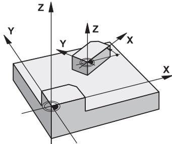
Innerhalb eines NC-Programms kann die Steuerung das Koordinatensystem in der Bearbeitungsebene um den aktiven Nullpunkt drehen.
