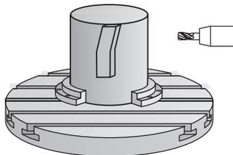
Mit diesem Zyklus können Sie eine Kontur auf dem Mantel eines Zylinders herstellen. Die Kontur definieren Sie dafür auf der Abwicklung eines Zylinders. Die Steuerung stellt das Werkzeug bei diesem Zyklus so an, dass die Wand der gefrästen Kontur bei aktiver Radiuskorrektur parallel zur Zylinderachse verläuft.
