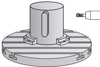
Mit diesem Zyklus können Sie einen auf der Abwicklung definierten Steg auf den Mantel eines Zylinders übertragen. Die Steuerung stellt das Werkzeug bei diesem Zyklus so an, dass die Wände bei aktiver Radiuskorrektur immer parallel zueinander verlaufen. Programmieren Sie die Mittelpunktsbahn des Stegs mit Angabe der Werkzeugradiuskorrektur. Über die Radiuskorrektur legen Sie fest, ob die Steuerung den Steg im Gleich- oder Gegenlauf herstellt.
