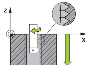
Zyklus **18 GEWINDESCHNEIDEN** fährt das Werkzeug mit geregelter Spindel von der aktuellen Position mit der aktiven Drehzahl auf die eingegebene Tiefe. Am Bohrungsgrund erfolgt ein Spindelstopp. An- und Abfahrbewegungen müssen Sie separat programmieren.
