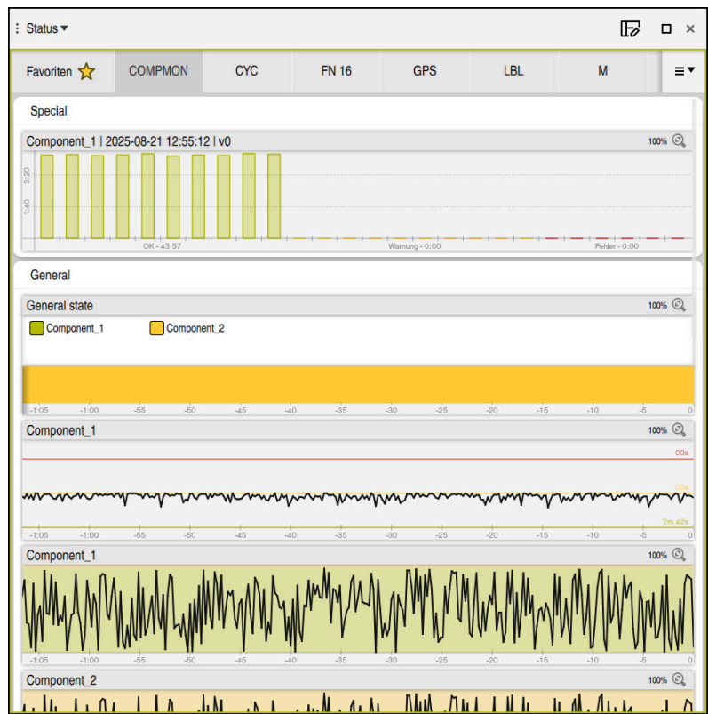
Reiter COMPMON mit konfigurierter Spindeldrehzahlüberwachung
