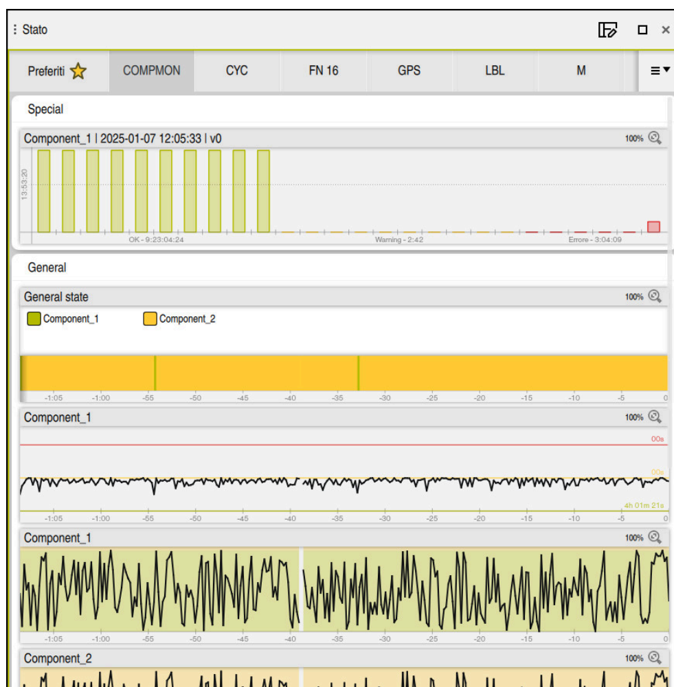
Scheda COMPMON con monitoraggio configurato del numero di giri mandrino
