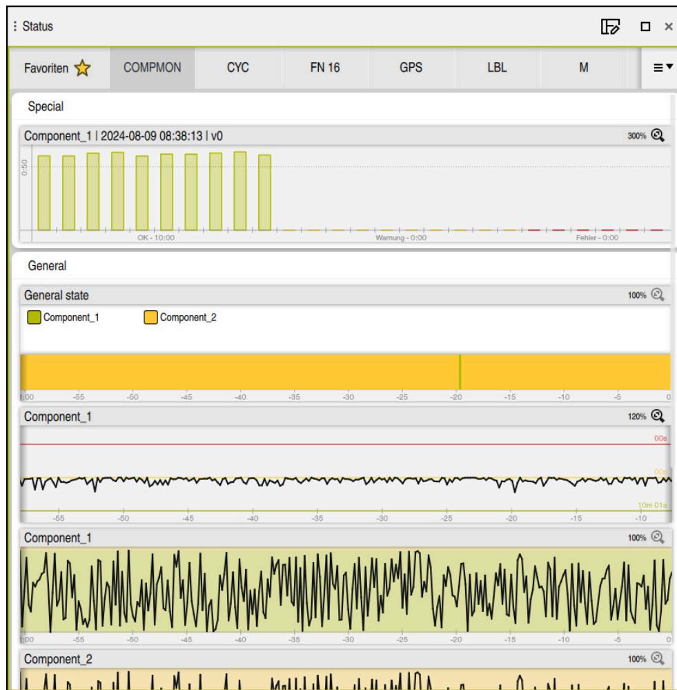
Reiter COMPMON mit konfigurierter Spindeldrehzahlüberwachung
