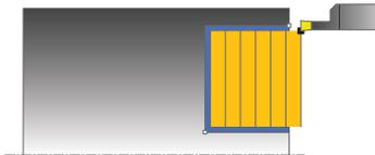
Com este ciclo, pode executar o torneamento de corte de ranhuras retangulares na direção transversal. Ao fazer o torneamento de corte, realizam-se alternadamente um movimento de punção à profundidade de corte e, em seguida, um movimento de desbaste. Deste modo, a maquinagem é feita com um mínimo de movimentos de elevação e avanço.
