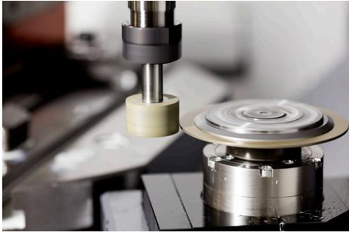
在修飾中，工件原點位於磨輪的邊緣上。使用循環程式**1030 ACTIVATE WHEEL EDGE**選擇個別邊緣。
