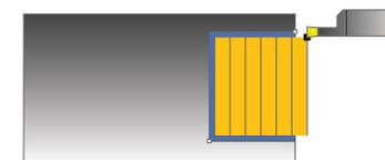
此循環程式能讓您在橫向方向內銑槽直角溝槽。銑槽車削時，銑槽前進至進刀深度，然後粗銑前進交替加工。加工處理需要最少次退刀和螺旋進給動作。
