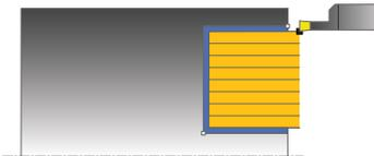
此循環程式能讓您執行直角溝槽的軸向銑槽(面銑槽)。
