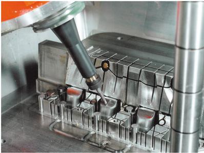
對於傾斜加工，也稱為傾斜刀具加工，刀具定位在使用者定義的工作平面角度。工作平面座標系統WPL-CS的方位不變，只改變旋轉軸的位置以及因此刀具位置。控制器可補償在線性軸內產生的偏移。
