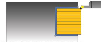
此循環程式能讓您執行溝槽的軸向銑槽(面銑槽)。功能的擴充範圍：
