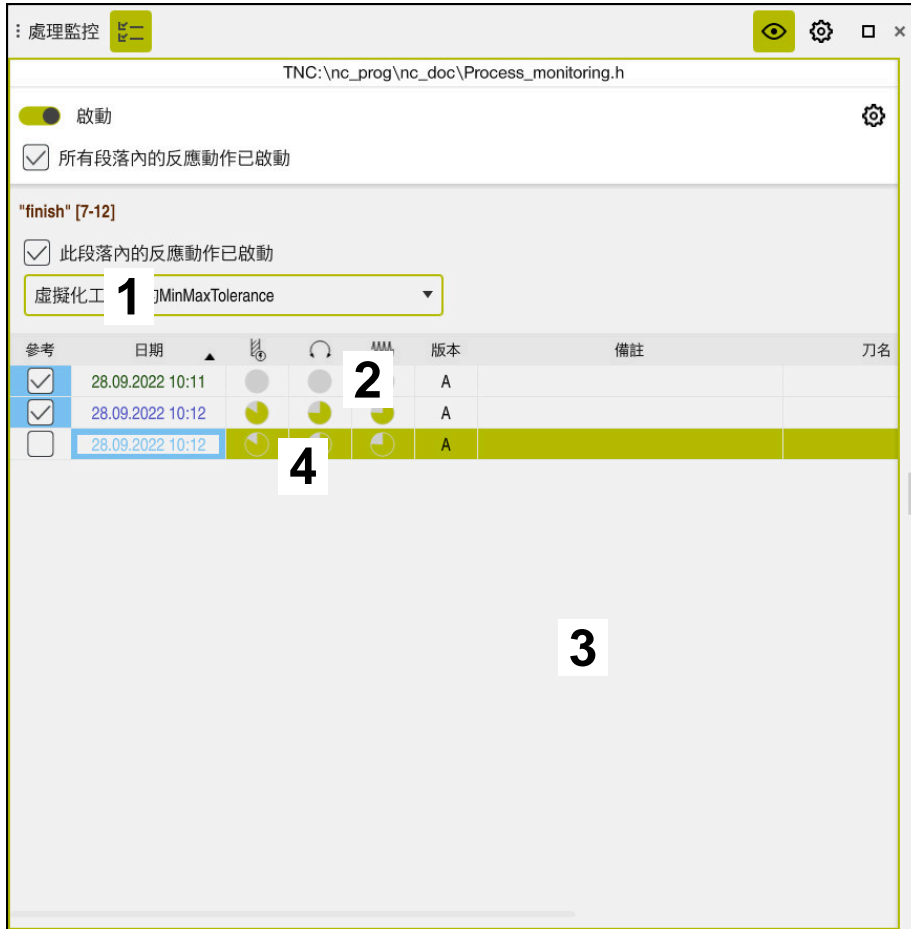
監控區段之內的監控選項欄
