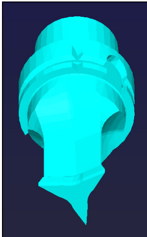
Modelo de portaherramientas para una herramienta FreeTurn
