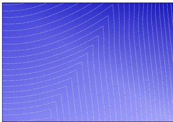
Trajectoires de l'outil avec d'importants changements de direction au niveau des transitions
