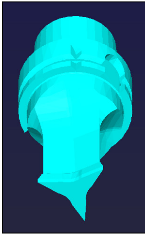
Værktøjsholderskabelon til et FreeTurn-værktøj
