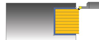
该循环用于加工轴向凹槽（端面凹槽）。扩展功能：
