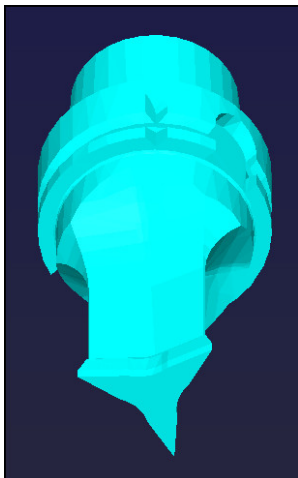
Šablóna nosiča nástrojov pre nástroj FreeTurn
