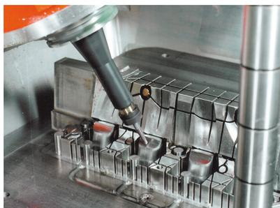
Per la lavorazione inclinata, denominata anche lavorazione a fresa inclinata, l'utensile si trova a una angolazione definita dall'operatore rispetto al piano di lavoro. Non si modifica l'orientamento del sistema di coordinate del piano di lavoro **WPL-CS**, ma esclusivamente la posizione degli assi rotativi e quindi l'inclinazione dell'utensile. Il controllo numerico può compensare l'offset che risulta quindi negli assi lineari.
