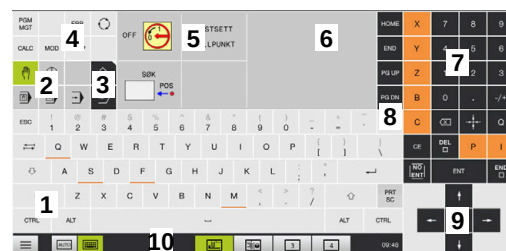
Kontrollpanel for driftsmodusen Manuell drift
