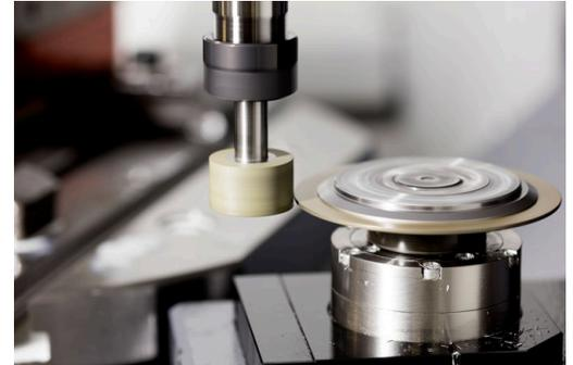
Als Abrichten bezeichnet man das Nachschärfen oder in Form bringen des Schleifwerkzeugs in der Maschine. Beim Abrichten bearbeitet das Abrichtwerkzeug die Schleifscheibe. Somit ist das Schleifwerkzeug beim Abrichten das Werkstück.
