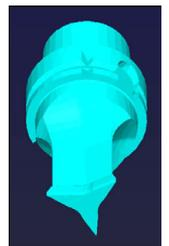
Werkzeugträgervorlage für ein FreeTurn-Werkzeug
