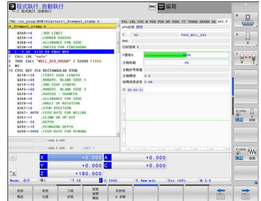
在可適化進給控制中，控制器於NC程式執行期間自動控制進給速率，做為目前主軸功率的功能。每次加工步驟所需要的主軸功率會在教學切削時決定，並由控制器儲存在屬於NC程式的一個檔案當中。在每次加工步驟開始時，通常當主軸開啟時，控制器控制進給速率，如此仍可保持在您所定義的極限內。
