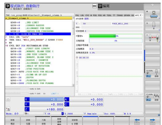
已設置工具機組件的監控(監控和監控細節標籤，選項155)
