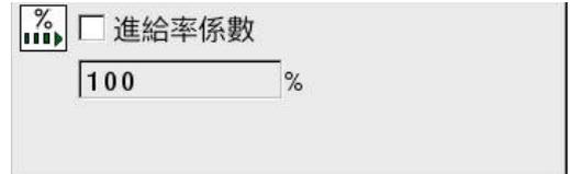
**覆寫進給速率**功能之**進階的機械設定**選項可讓您修改當前加工進給速率。該輸入對應至百分比。輸入範圍：1%到1000%
