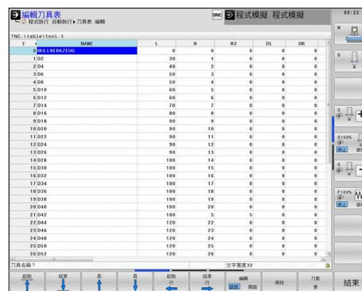
**i** 若編輯刀具表，則會鎖定選取的刀具。若在使用的NC程式當中需要此刀具，則控制器顯示下列訊息：**刀具表已鎖定**。
