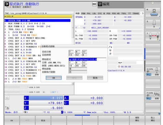
在程式執行操作模式中，您可使用**自動啟動**軟鍵，以定義一特定時間來啟動目前在此操作模式中所啟用的NC程式：
