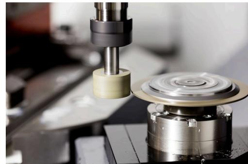
Por dressagem entende-se o reafinamento ou a colocação em forma da ferramenta de retificar na máquina. Durante a dressagem, a ferramenta de dressagem machuca o disco de polimento. Assim, ao dressar, a ferramenta de retificar é a peça de trabalho
