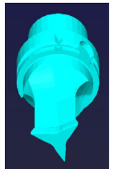
Gereedschapshoudersjabloon voor een FreeTurn-gereedschap
