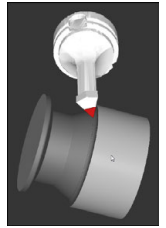
FreeTurn-gereedschap bij de simulatie
