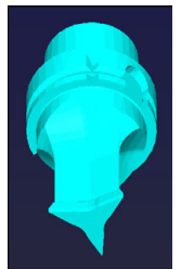
FreeTurn刀具的刀座模板
