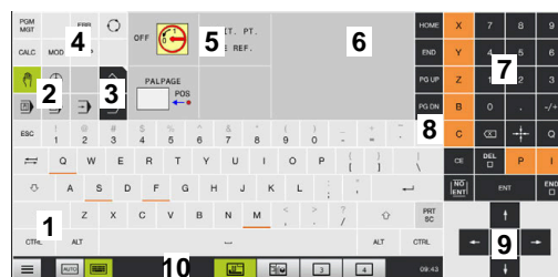
Panneau de commande du Mode manuel
