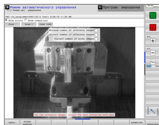
9 Завершите процесс, нажатием программной клавиши **ВЕРНУТЬСЯ**. Система ЧПУ вернётся в режим отработки программы
