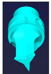
Werkzeugträgervorlage für ein FreeTurn-Werkzeug
