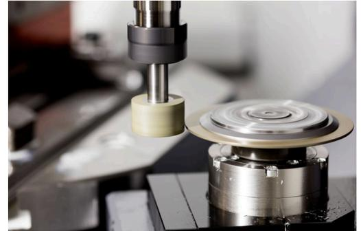
Le "dressage" désigne le réaffûtage ou la mise en forme d'un outil de rectification sur la machine. Lors du dressage, l'outil à dresser usine une meule. De fait, la meule se trouve être la pièce de l'opération de dressage.
