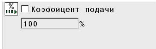
При помощи настройки **Коэффициент подачи** функция **Глобальные настройки программы** позволяет управлять текущей подачей для обработки. Ввод соответствует значению в процентах. Диапазон вводимых значений: от 1 % до 1000 %.
