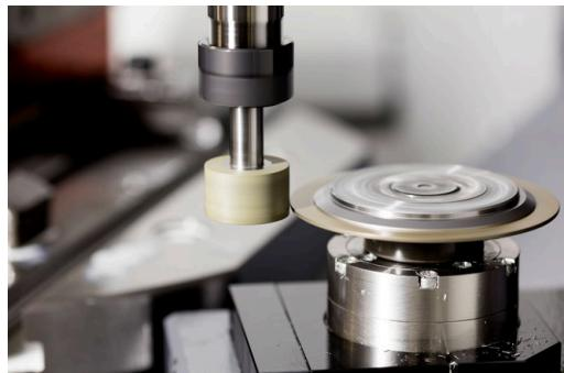
“修整”是指在机床内使砂轮锋利或砂轮形状准确。在修整期间，修整机加工砂轮。因此，修整中的砂轮是工件。
