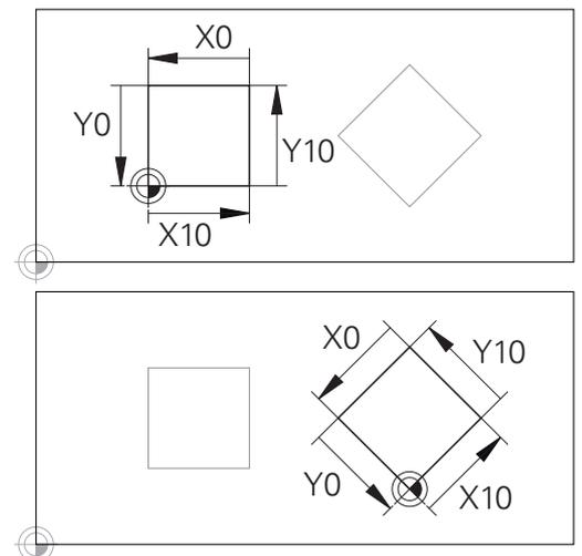
Obrys vzťahujúci sa na začiatok vstupného súradnicového systému sa dá ľubovoľne transformovať veľmi jednoducho.
