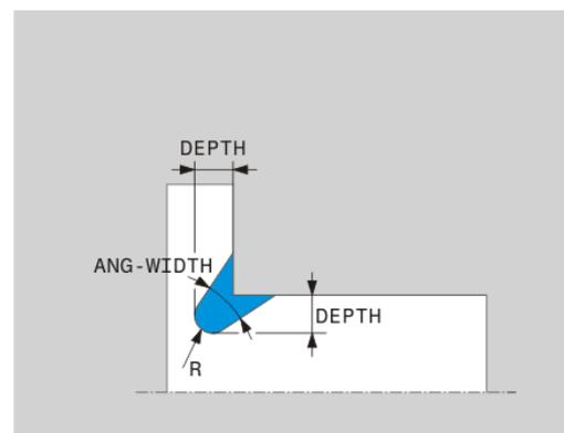
**Odl'ahčovací zápich UDC TYPE\_U****Vstupné parametre v odl'ahčovacom zápichu UDC TYPE\_U**
