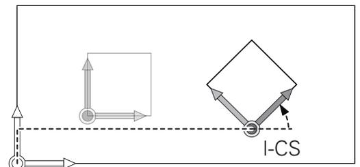
Transformácie v súradnicovom systéme roviny obrábania:
