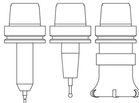
V súlade s hodnotami z tabuľky nástrojov sa počiatok súradnicového systému nástroja presunie na vodiaci bod nástroja TCP. TCP je skratka pre spojenie **Tool Center Point**.
