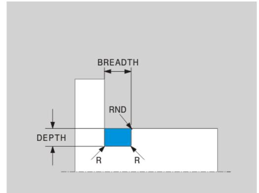
**Odl'ahčovací zápich UDC THREAD****Vstupné parametre v odl'ahčovacom zápichu DIN 76 UDC THREAD**
