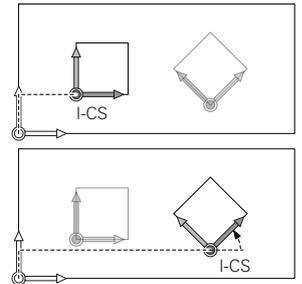
**i** Bez aktívnych transformácií v súradnicovom systéme roviny obrábania sa poloha a orientácia vstupného súradnicového systému a súradnicového systému roviny obrábania zhodujú.
