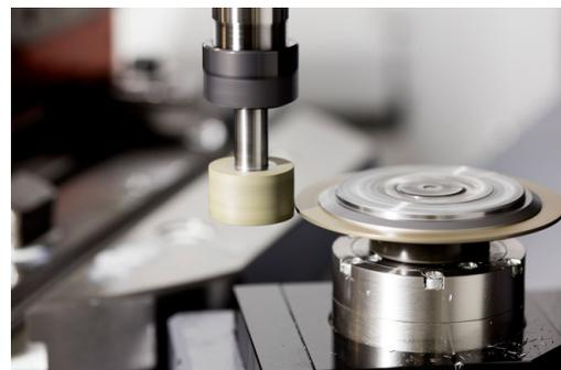
Le "dressage" désigne le réaffûtage ou la mise en forme d'un outil de rectification sur la machine. Lors du dressage, l'outil à dresser usine une meule. De fait, la meule se trouve être la pièce de l'opération de dressage.
