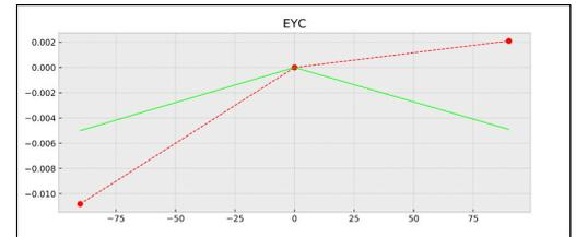
Ejemplo de medición EYC: errores de componentes en Y del eje C
