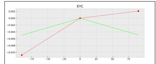
Ejemplo de medición EYC: desviaciones del eje Y en función del eje C
