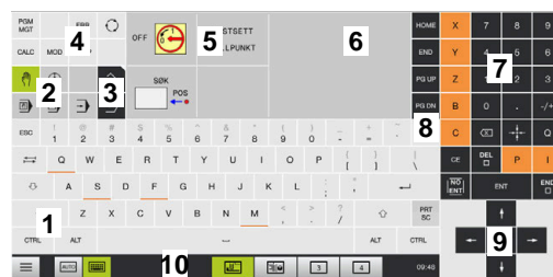
Kontrollpanel for driftsmodusen Manuell drift
