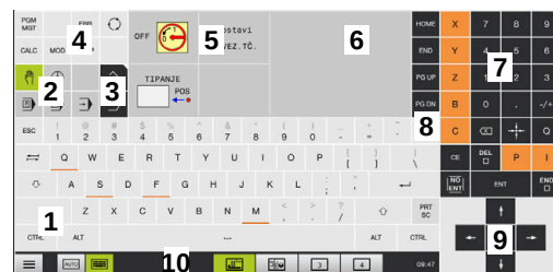
Nadzorna plošča načina delovanja Ročno navedbo
