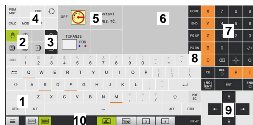
Nadzorna plošča načina delovanja Ročno delovanje
