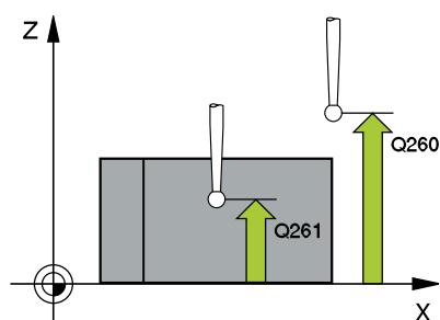
**帮助图形****参数****Q301 移动到接近高度 (0/1)?**
