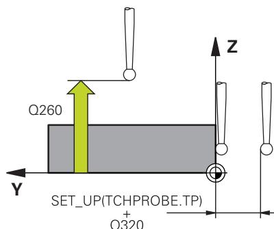
**Q320 安全高度？**触点与球头间的附加距离。**Q320**是在探测表中SET\_UP列的基础上的补充。该值提供增量效果。
