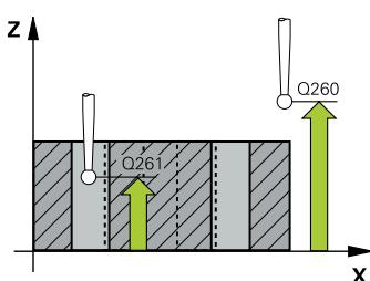
**Q261 探針軸上的量測高度?**
