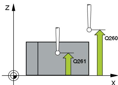
**說明圖****Parameter****Q301 移到淨空高度(0/1)?**
