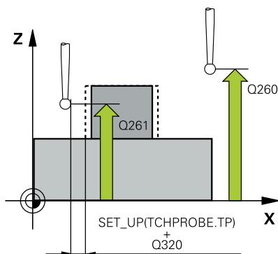
**說明圖****Parameter****Q301 移到淨空高度(0/1)?**
