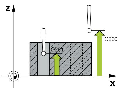
**Q261 探針軸上的量測高度？**
