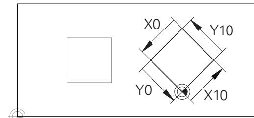
參考輸入座標系統原點的輪廓可依照需求簡單轉換。
