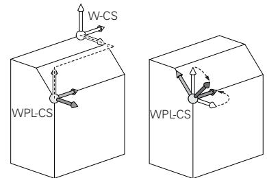
在工作平面座標系統內，使用者使用轉換來定義輸入座標系統的位置與方位。
