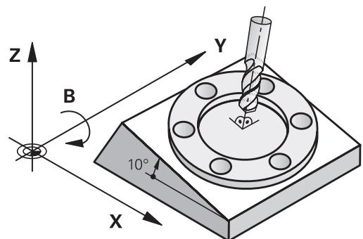
**i** 控制器只支援**傾斜工作面**功能結合主軸Z。
