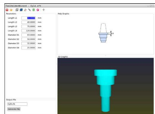
**i** 若刀具台車樣本不含任何轉換向量、名稱、測試點或量測點，則當啟動對應圖示時，額外的**ToolHolderWizard**工具不會執行任何功能。
