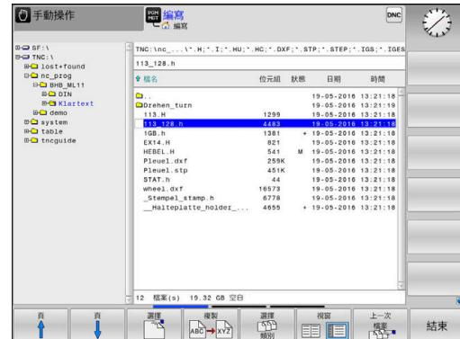
左邊的較小視窗顯示可用的磁碟機與目錄。磁碟機代表了儲存或傳輸資料的裝置，磁碟機就是控制器的內部記憶體，其他磁碟機是介面(RS232、乙太網路)，可用來例如連接PC。一個目錄的識別方式皆為左方為資料匣符號，而右方為目錄名稱。子目錄顯示在其母目錄右下方。若有子目錄，可使用-/+鍵顯示或隱藏。
