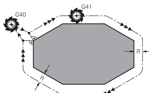
一旦刀具已呼叫並且以在工作平面內以上面提及的直線單節之內或近軸動作之內的刀徑補償之一移動時，該刀徑補償生效。
