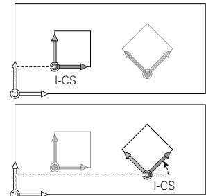
在輸入座標系統內定位單節的幫助之下，使用者定義刀具位置，並因此定義刀具座標系統的位置。
