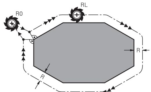
一旦刀具已呼叫並且以在工作平面內以上面提及的直線單節之內或近軸動作之內的刀徑補償之一移動時，該刀徑補償生效。
