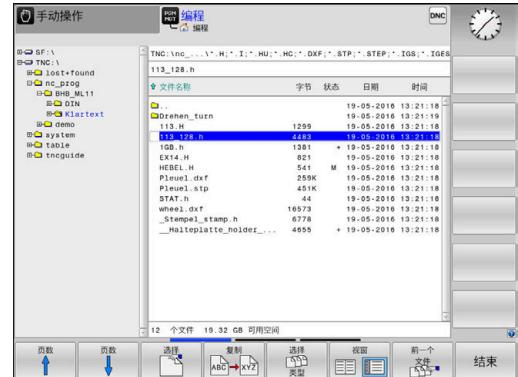
该数控系统自动生成NC程序的第一和最后一个NC程序段。然后，将不允许修改这些NC程序段。
