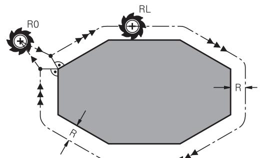
对于半径补偿，数控系统考虑**TOOL CALL**（刀具调用）程序段和刀具表中的差值：
