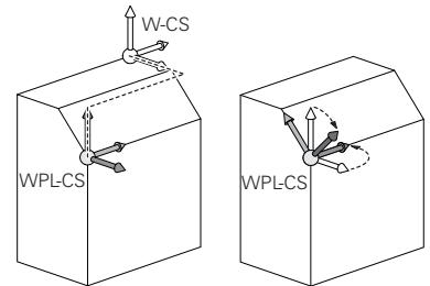
在加工面坐标系中，用户用变换定义输入坐标系的位置和方向。
