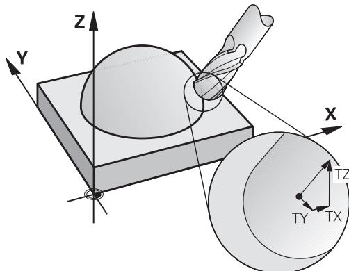
如果在**LN**程序段中未定义刀具定向和**TCPM**被激活，数控系统保持刀具垂直于工件轮廓。
