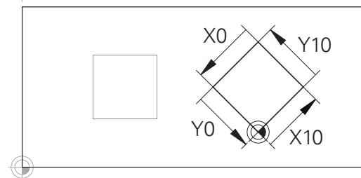
基于输入坐标系原点的轮廓可轻松根据需要变换。
