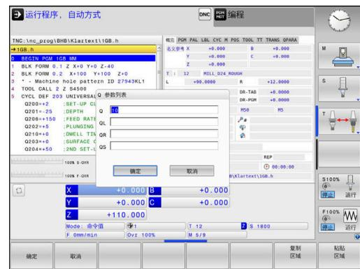
在所有操作模式下（除**编程**操作模式外）都可使Q参数在附加状态栏中显示。
