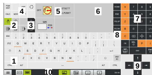
Kontrollpanel for driftsmodusen Manuell drift
