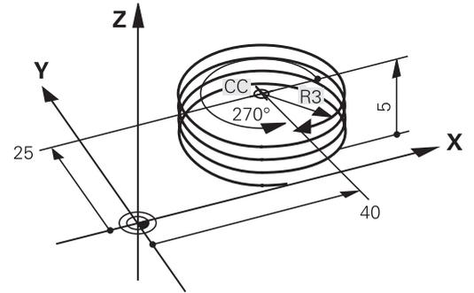
NC程序段举例：M6 x 1 mm螺纹，5扣
