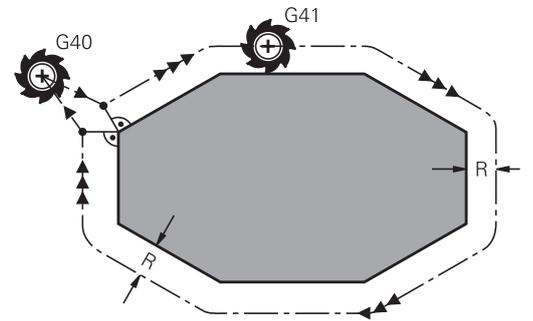
对于对刀具半径补偿，TNC系统考虑（刀具调用）**T**程序段和刀具表中的正差值因素：
