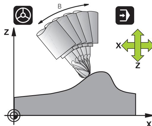
TCPM功能是对M128功能的改进，用它可以在定位旋转轴时确定TNC的特性。与M128不同，TCPM功能允许定义多个功能的动作模式：
