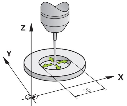
校准球头半径时，TNC执行自动探测程序。第一次探测循环期间，TNC确定环规或量杆的中心（大致测量）并使测头在中心位置。然后，在实际校准过程（最终测量）中确定球头半径。如果允许测头从反向探测，将在另一个循环中确定偏心量。
