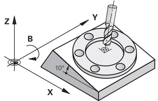
TNC支持可旋转主轴头及/或可回转工作台机床的倾斜加工面功能。典型应用包括在倾斜平面上钻斜孔或加工倾斜轮廓。加工面总是围绕当前原点倾斜。与在主平面（如X/Y平面）上编程一样，但是在执行时，加工面将相对主平面倾斜一定角度。
