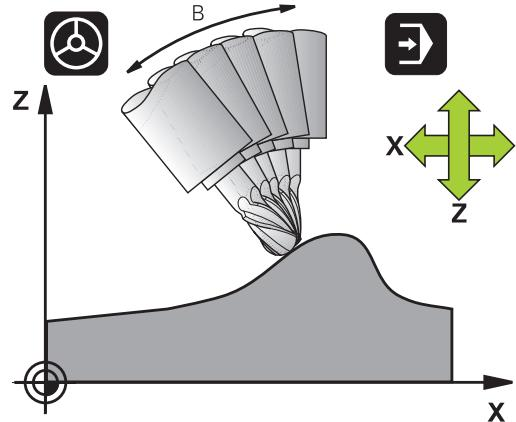
**TCPM 功能**為對於**M128** 功能的一種改良，您可用以在定位旋轉軸時定義TNC的行為。相反於**M128**，使用**TCPM功能**時您可定義多個功能的動作模式：
