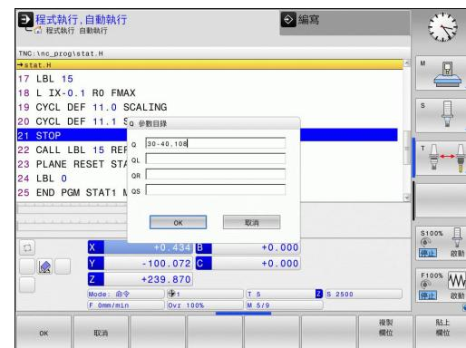
在「手動」、「電子手輪」、「單一單節」、「完整順序」以及「程式模擬」操作模式的額外狀態顯示中可顯示Q參數。
