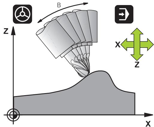
如果控制的傾斜軸的位置在程式內被改變，刀尖與工件的位置距離仍然維持不變。
