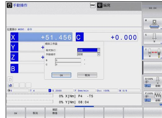
要重設傾斜功能，請在**傾斜工作平面**功能表中將所需的操作模式設定為不作用。
