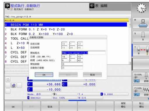
在程式執行操作模式中，您可使用「自動開始」軟鍵(參見右上圖)，以定義一特定時間來啟動目前在此操作模式中所啟用的程式。
