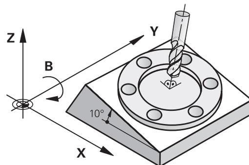
Il TNC supporta la rotazione dei piani di lavoro su macchine utensili con teste o tavole orientabili. Applicazioni tipiche sono, ad es., fori obliqui o profili posti in modo obliquo nello spazio. Il piano di lavoro viene sempre ruotato intorno al punto zero attivo. La lavorazione viene programmata come d'abitudine in un piano principale (ad es. piano X/Y) mentre l'esecuzione viene realizzata in un piano ruotato rispetto al piano principale.
