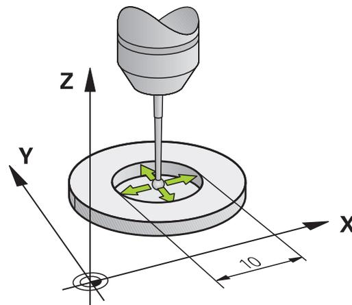
Per la calibrazione del raggio della sfera il TNC esegue una routine di tastatura automatica. Nella prima passata il TNC determina il centro dell'anello di calibrazione o della spina (misurazione approssimativa) e posiziona il tastatore al centro. Quindi nell'operazione di calibrazione vera e propria (misurazione precisa) viene determinato il raggio della sfera. Se è possibile eseguire una misurazione a ribaltamento con il tastatore, l'offset viene determinato in una passata.
