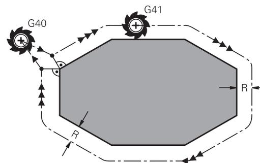
Per la correzione del raggio il TNC tiene conto dei valori delta sia del blocco **T** che della tabella utensili.
