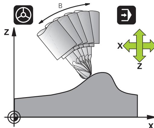
**FUNCTION TCPM** è uno sviluppo della funzione **M128**, con cui si può definire il comportamento del TNC nel posizionamento di assi rotativi. A differenza di **M128**, con **FUNCTION TCPM** è possibile definire autonomamente il comportamento di diverse funzionalità:
