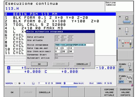
Con il softkey AUTOSTART (vedere figura in alto a destra), è possibile, in uno dei modi operativi di Esecuzione programma, avviare il programma attivo in un determinato momento programmabile:
