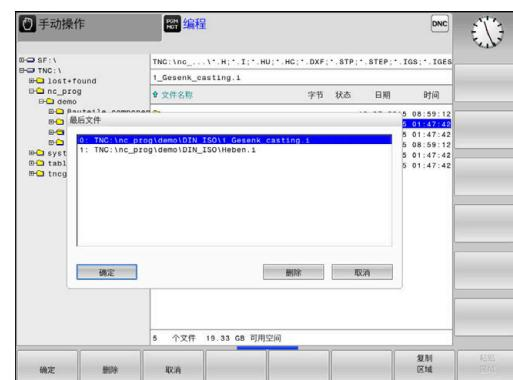
**i** 用**复制区域**软键可以复制被标记文件的路径。复制的路径可以多次使用，例如用**PGM CALL**键调用一个程序时。
