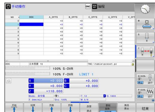
该数控系统转换机床坐标系的所有运动，与参考坐标系的输入值无关。
